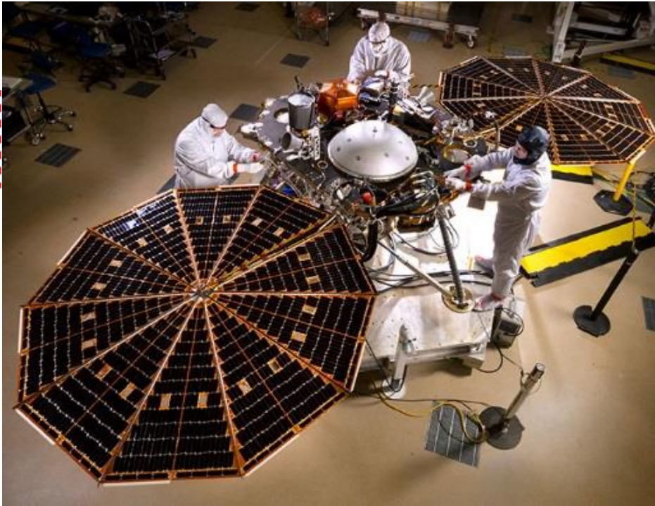
Les panneaux solaires de l'atterrisseur InSight déployés lors d'un test dans une salle blanche au Lockheed Martin Space Systems, Denver. La configuration correspond à ce que ressemblera l'atterrisseur sur la surface de Mars. Crédit image: NASA/JPL-Caltech/Lockheed Martin
